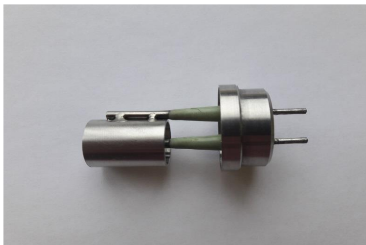
Фото 2 Конденсатор измерительный БЫ5.183.119
